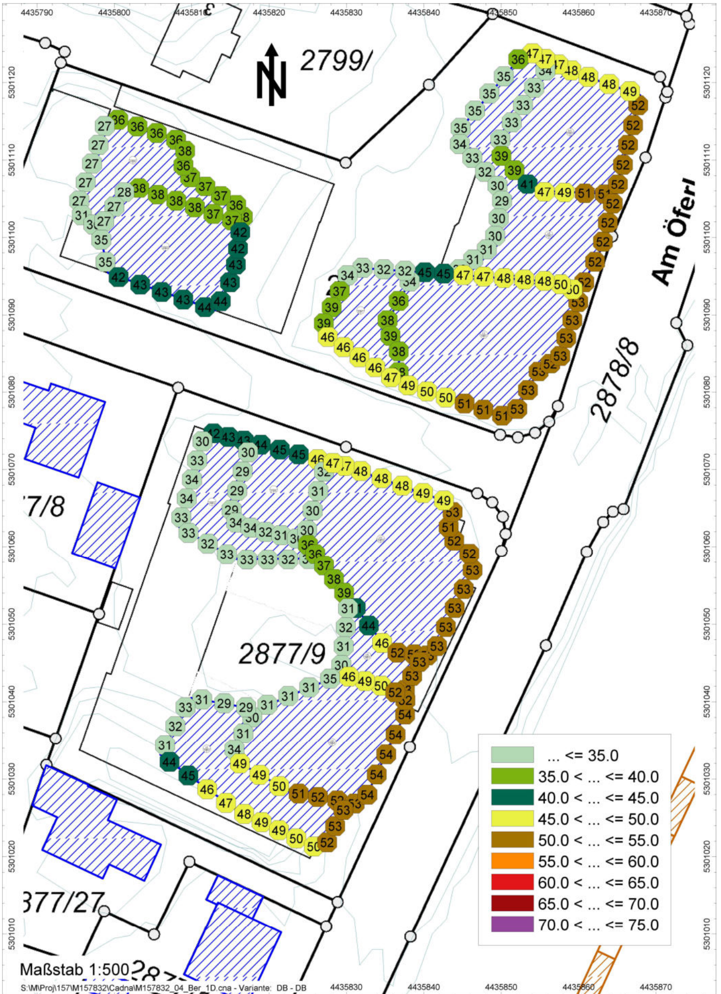
Bebauungsplan "Hangstraße / Am Öferl", Weilheim Gebäudelärmkarte Schienenverkehr, NACHT, lautestes Stockwerk M157832/04 SMK August 2022
